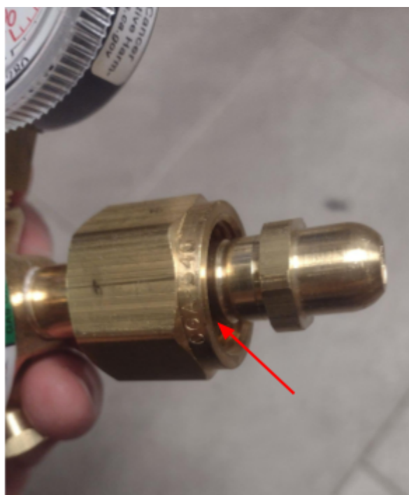
Repare na marca "CGA540" na porca.
